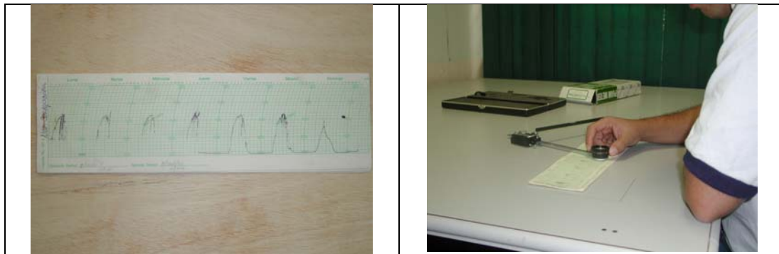
Figura 2-1 (a) Ejemplo de una banda de radiación solar, (b) Método del planímetro para recuperación de la información de radiación para el proyecto de Solarimetría.
